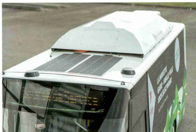
La navette dispose de trois panneaux solaires pour alimenter les systèmes électriques à bord.
